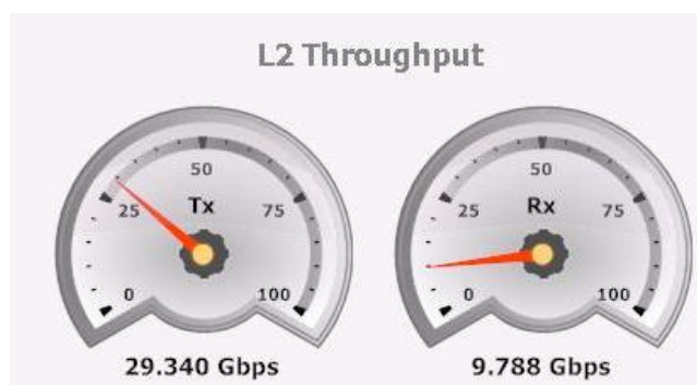
Figura 60 Tasa máxima DL medido a nivel Ethernet sobre una ONT XGS-PON con jumbo frame sin FEC
