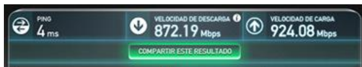
Figura 78 Test de velocidad con SpeedTest.net con XGS-PON
