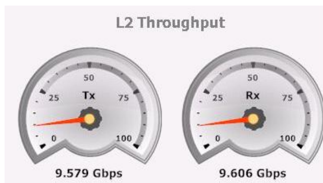
Figura 59 Tasa máxima UL medido a nivel Ethernet empleando dos ONTs XGS-PON
