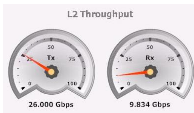
Figura 58 Tasa máxima DL medido a nivel Ethernet sobre dos ONTs XGS-PON
