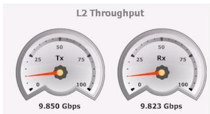
Figura 56 Tasa máxima DL medido a nivel Ethernet sobre ONT XGS-PON
