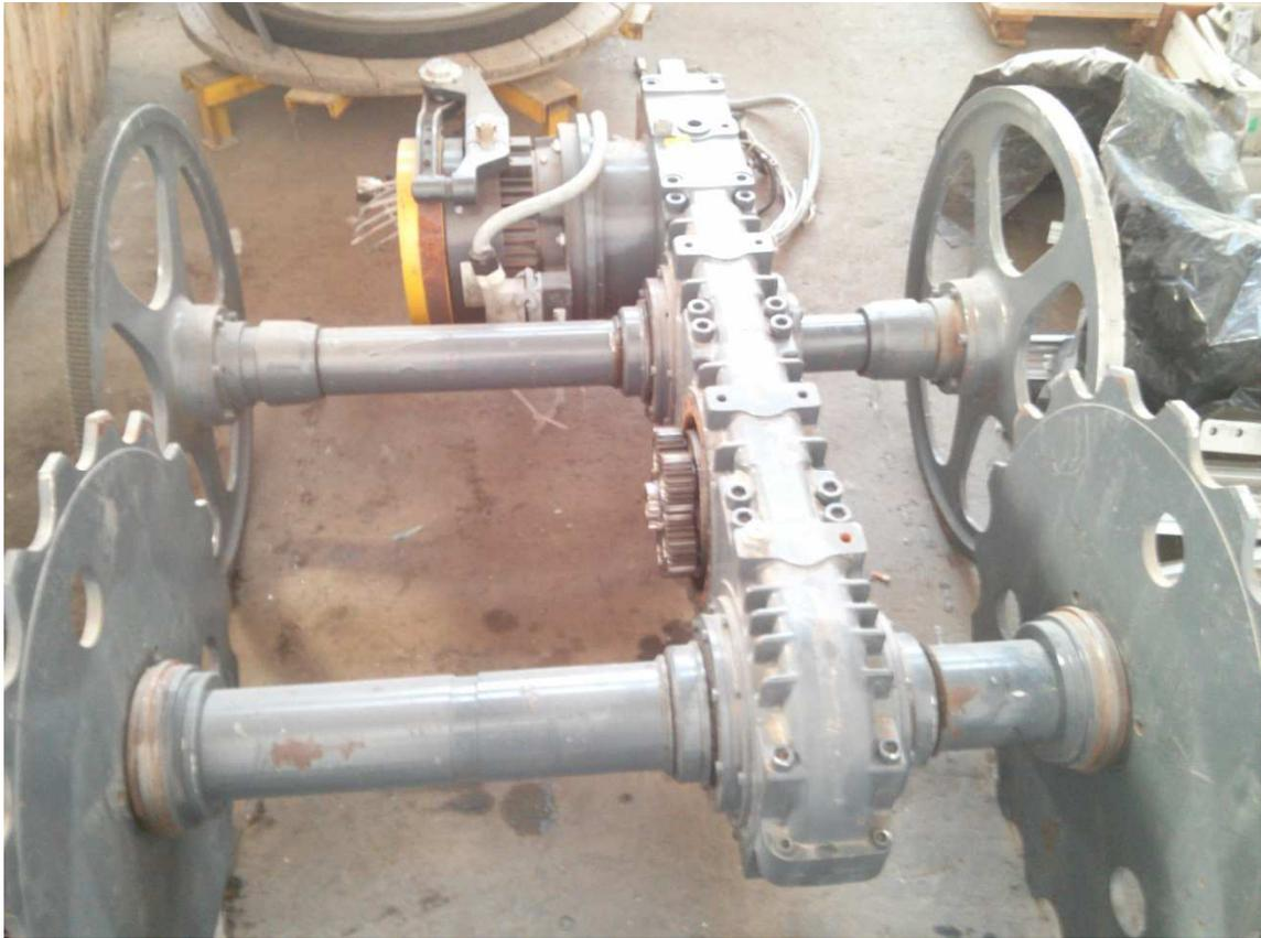
**Figura 43 Sistema completo motor-reductor Kone Eco3000**
